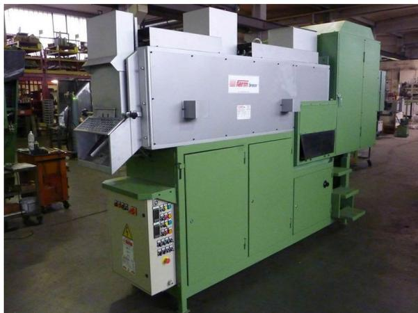
Forno a gas FARM BRASS usato a 3 guide per il riscaldamento di billette di ottone per lo stampaggio a caldo.
